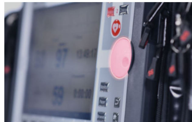
▲ Alarmvisualisierung durch leuchtendes Jog-Dial und Warntöne.
