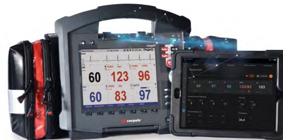
Über eine bi-direktionale Bluetooth-Schnittstelle können alle wichtigen Daten auch direkt mit dem corpuls3 oder C3T ausgetauscht werden.
