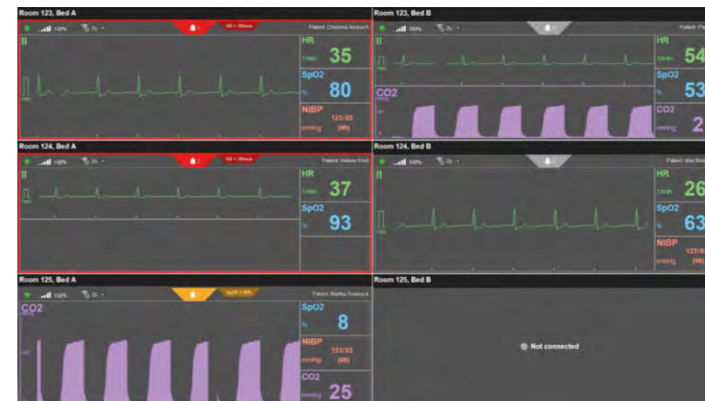
Mit der Funktion LIVE Board ist eine einfache Überwachung mehrerer Patienten gleichzeitig mit frei wählbaren Ansichten möglich. Sie können die Echtzeitdaten einer Vielzahl von corpuls3 -Geräten in beliebigen Kacheln auf mehreren Bildschirmen zur Anzeige bringen.
