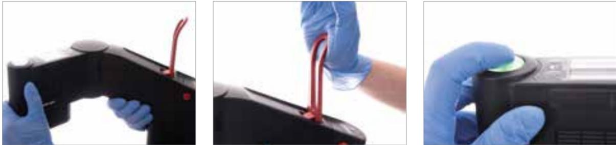
▲ Im Anschluss wird der **corpuls cpr**-Arm auf dem Thorax ausgerichtet. Der **corpuls cpr**-Arm wird in Höhe und Winkel angepasst und ein Helfer richtet den Stempel exakt aus. Sofort nach der Positionierung wird der **corpuls cpr**-Arm durch Schließen des Hebels arriert und die mechanische Thoraxkompression durch Drücken des Start/Stop-Buttons gestartet.
